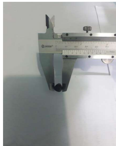
Gambar 3.1 Proses Pengukuran Diameter Biji
