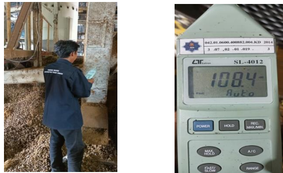
Gambar 3.1 Proses Saat Pengukuran Kebisingan Pada Mesin Destoner
