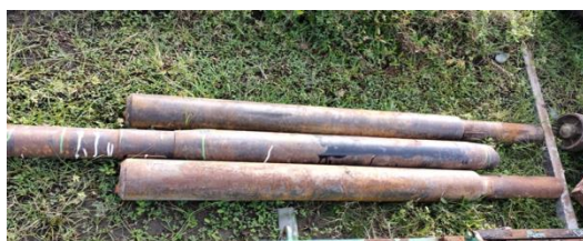
Gambar 9 : Patahan Shaft di lapangan (Sumber : PT Mifa Bersaudara)
