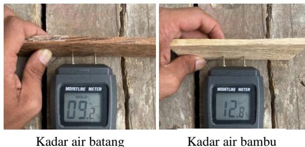
Gambar 3. Kadar air batang kelapa dan bambu duri
