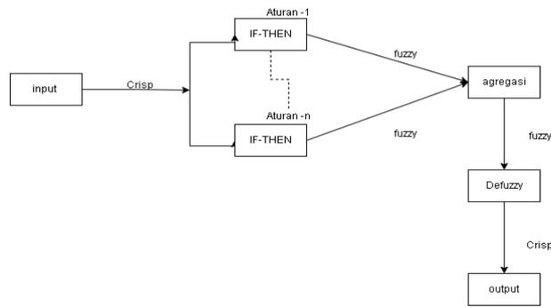
Gambar 2. Diagram Blok Sistem Inferensi Fuzzy
