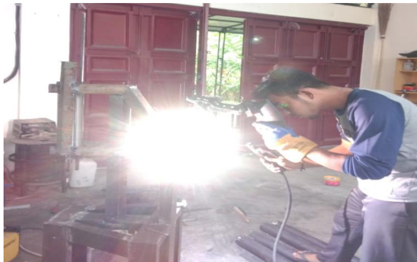
Gambar 3. Proses Pembuatan Alat Power Forging Hammer
