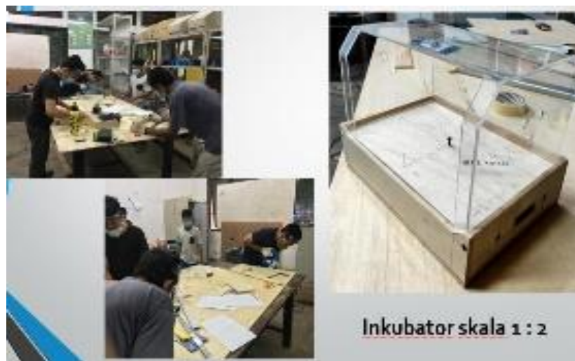
Gambar 8. Fabrikasi mini incubator skala 1:2
