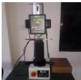
Gambar 5. Alat Uji Kekerasan Brinell
