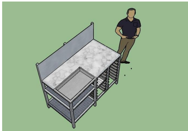
Gambar 11. Perancangan Usulan Fasilitas Meja Kerja Penggorengan Tampak Atas
