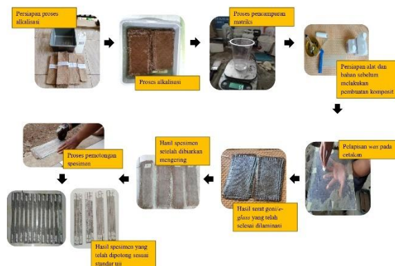
Gambar 2 Proses pembuatan spesimen komposit
