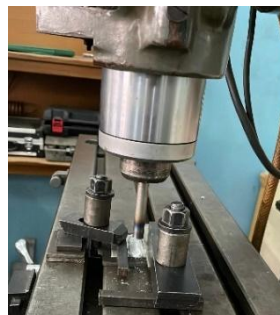
Gambar 6. Proses Penyambungan spesimen benda kerja
