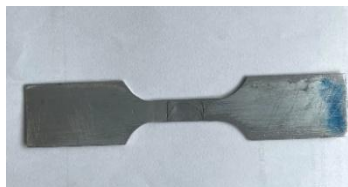
Gambar 9. Spesimen uji tarik sesudah menjadi standar ASTM E8
