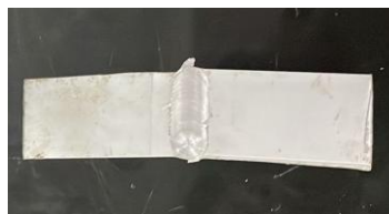
Gambar 9. Spesimen uji tarik sebelum menjadi standar ASTM E8
