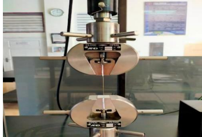
Gambar 5. Proses Pemasangan Spesimen uji (Serat)
