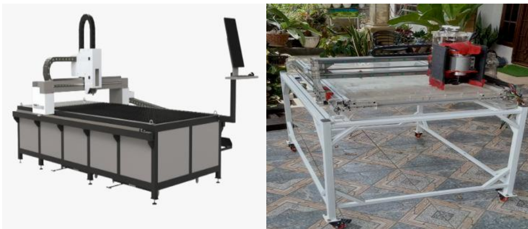
Gambar 3. Desain Perancangan Mesin CNC Drilling dan Grafir Berbasis Arduino Mega 2560
