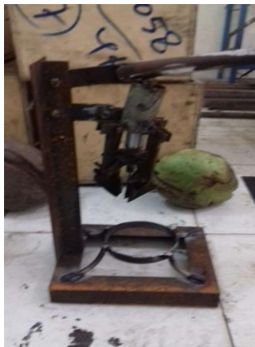
Gambar 6. Gambar alat bantu pembelah buah durian yang telah dirakit
