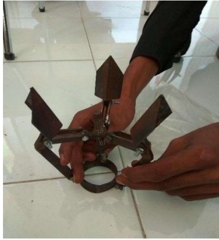
Gambar 5. Gambar komponen pendorong mata pisau
