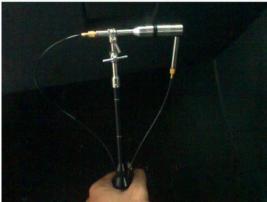
Gambar 6. Pengukuran Sound Pressure Level (SPL) dengan menggunakan Sound Intensity
