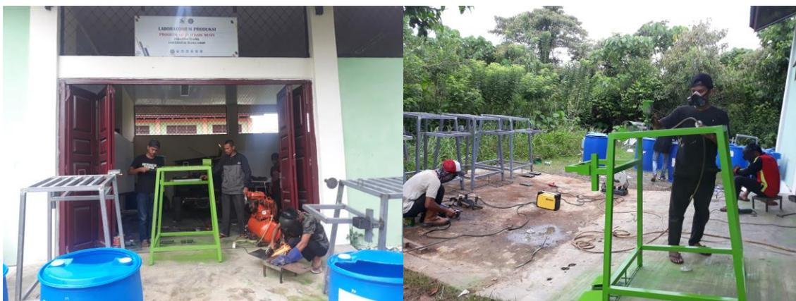
Gambar 3 Proses produksi *Touchless Hand Washer* di Laboratorium Teknik Mesin Fakultas Teknik, Universitas Teuku Umar, Aceh
