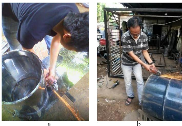
Gambar 1. Proses perancangan *kiln* : a. pembuatan tabung penyimpanan tempurung kemiri, b. pembuatan tabung tungku pembakaran
