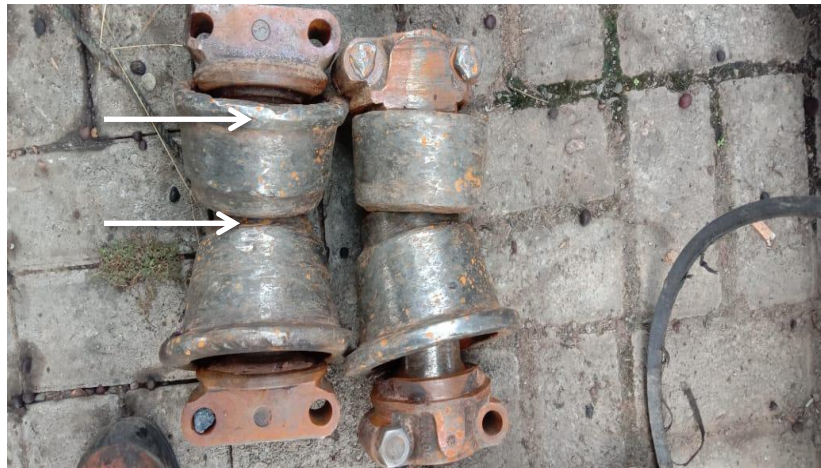
Gambar 2. Track Roller mengalami keausan pada PT. Beurata Subur Persada
