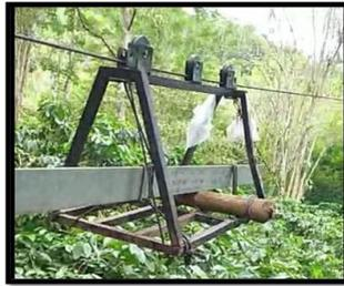
**Gambar 4.** Alat Pengangkut Material atau *Bucket*
