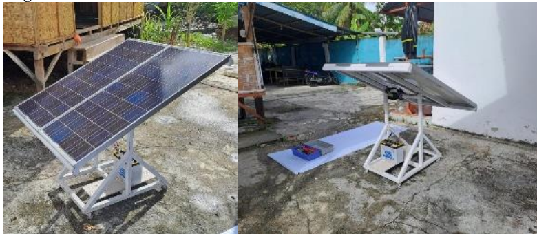
Gambar 6. Hasil rancang bangun solar cell yang di rangkai parallel
