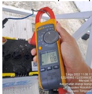
Gambar 5. Pengukuran nilai arus yang mengalir ke akumulator
