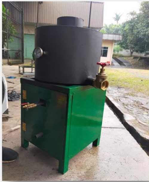
Gambar 3. Hasil Pembuatan Alat Pelebur Sampah Plastik
