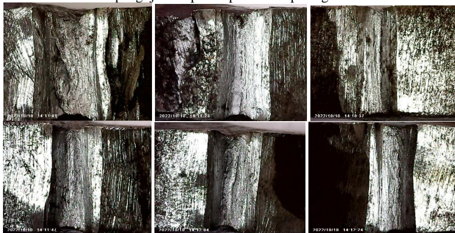
Gambar 5. Patahan Spesimen 80 dan 85 Ampere
