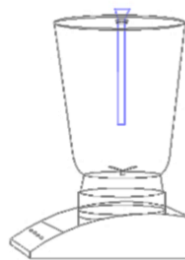
Gambar 5. Sketsa desain blender sebelum dimodifikasi
