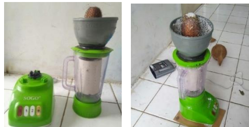
Gambar 10. Hasil Akhir Manufaktur Mesin Produksi Santan Sumber : (Penelitian, 2020)
