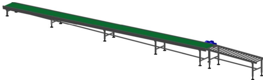
Gambar 4 Perancangan Belt Conveyor dengan AutoCAD
