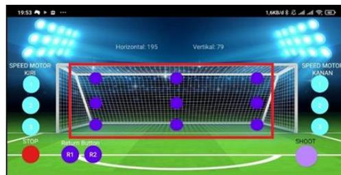
**Gambar 3.** Tombol Arah Lontaran pada Tampilan *User interface* Kendali *Ball launcher*
