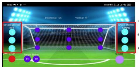
**Gambar 5.** Tombol Kecepatan pada Tampilan *User interface* Kendali *Ball launcher*
