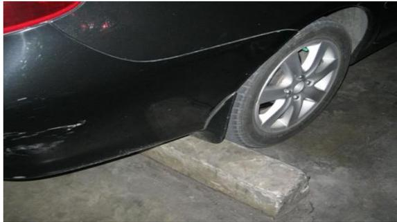
Gambar 5 *Parking bumper* dari bahan komposit beton
