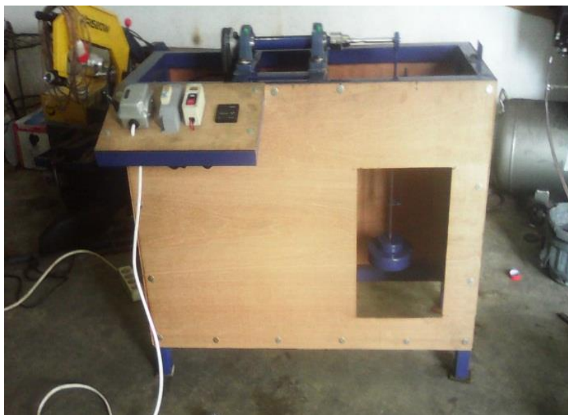
Gambar 4. Mesin uji lelah tipe cantilever rotating bending
