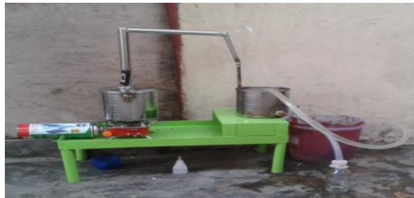
Gambar 9. Alat Penghasil Bioetanol Skala Prototype Tabel 3. waktu yang dibutuhkan dalam proses pembuatan alat.
