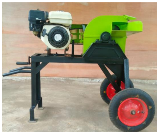
Gambar 2. Mesin perajang hijauan multifungsi
