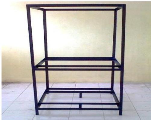
Gambar 9. Rangka Alat Uji Jominy
