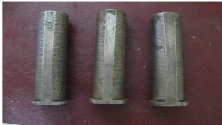
Gambar 17. Spesimen alat uji jominy
