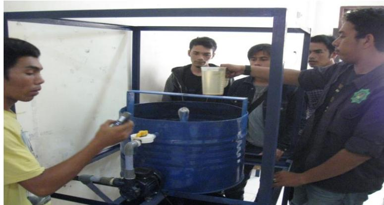
Gambar 16. Pengukuran kecepatan alir air
