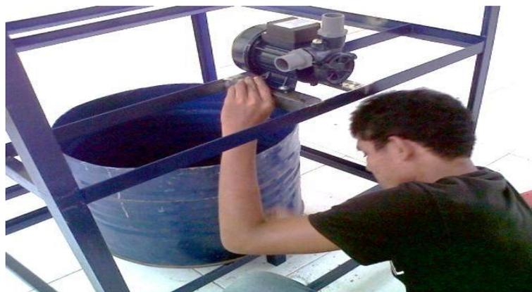
Gambar 13. Pemasangan pompa air
