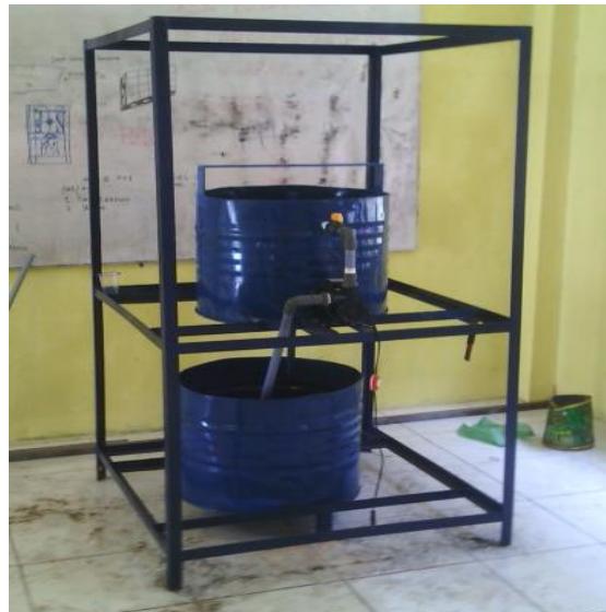
Gambar 15. Produk akhir alat uji Jominy
