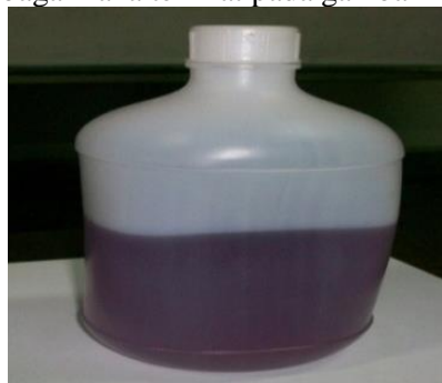
Gambar 1. Resin dengan jenis Unsaturated polyester resin tak jenuh (BQTN157)
