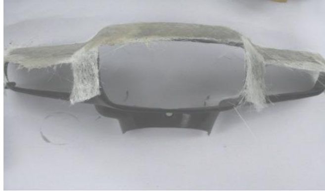
Gambar 9. Hasil setelah proses hand lay up pada lapis 1
