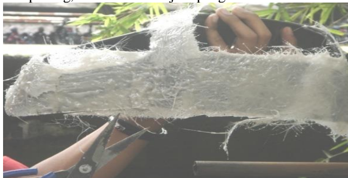
Gambar 11. Pemotongan serat pada tepi cetakan
