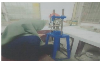
Gambar 4. Pengujian pepadatan kuat tekan bebas
