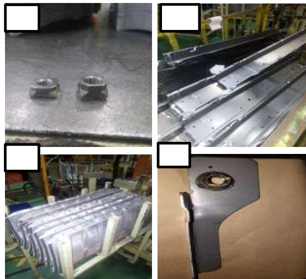
Gambar 2 Nut M6 (1), Single Part AAS-050 (2), Bracket AAS-018 (3), Bracket AAS-016 (4).
