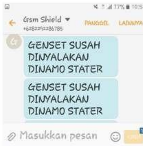
Gambar 11. Hasil Pengujian Pemberitahuan SMS Genset Trouble
