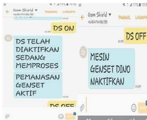
Gambar 12. Hasil Pengujian Pemberitahuan SMS Pemanasan Genset
