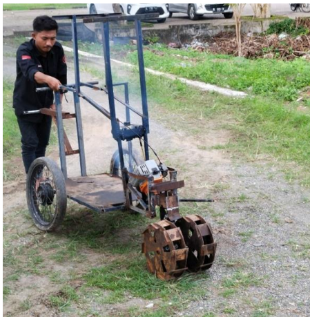
Gambar 8. Uji coba roda bersirip di lahan tanah darat
