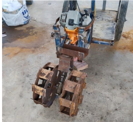
Gambar 7. Roda bersirip yang sudah terpasang di rangka mesin
