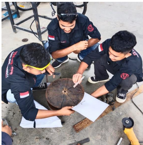
Gambar 4. proses perhitungan sudut sirip pada diameter luar roda
