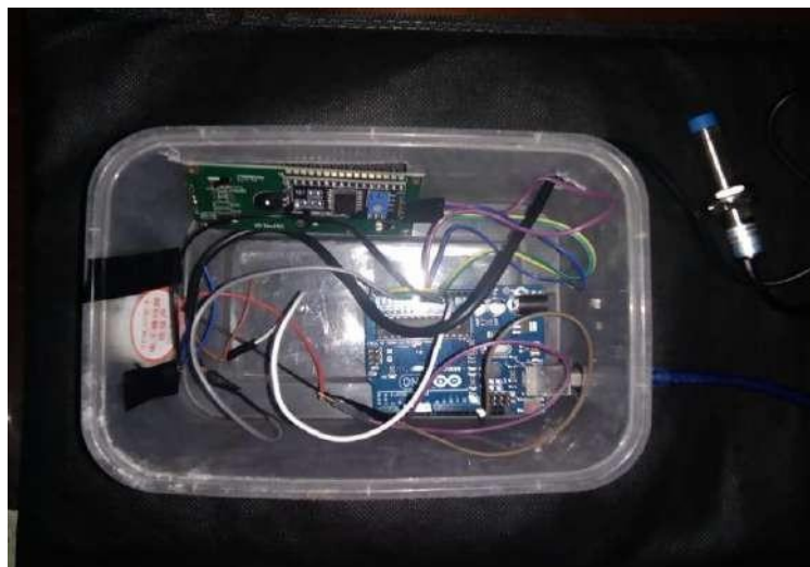
Gambar 6 Implementasi Perangkat Keras Alat MD Prox
