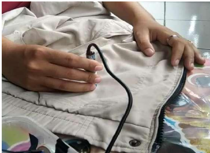
Gambar 7 Pendeteksian Logam Pada Saku Pakaian
