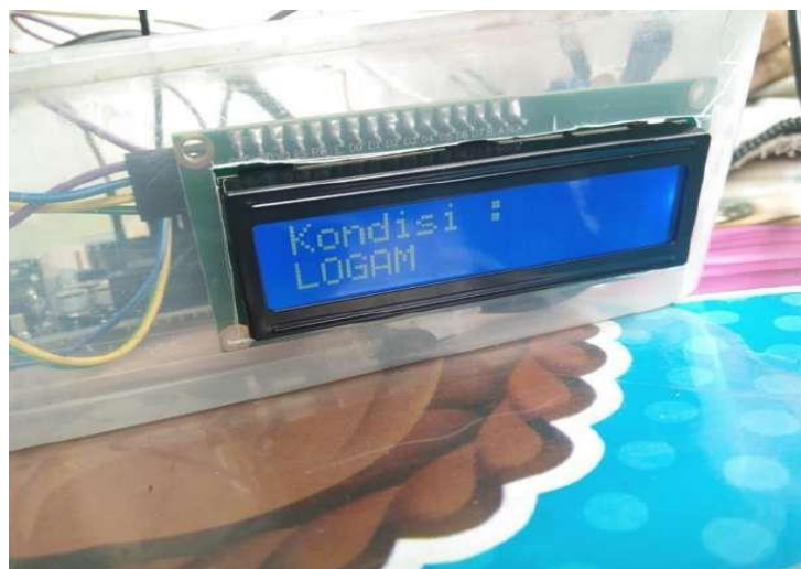
Gambar 8 Alat Berhasil Mendeteksi Logam di dalam Saku Pakaian
