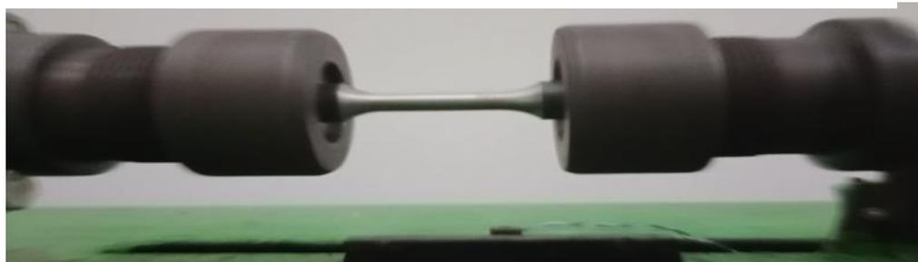
**Gambar 6.** Spesimen Yang Telah Dipasang Pada Chuks
