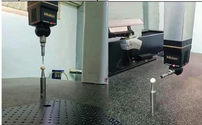
Gambar 6. Proses Kalibrasi Probe Sentuhan
