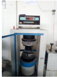
Gambar 2 Pengujian Kuat Tekan Benda Uji
