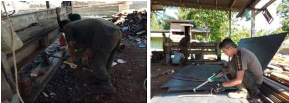
**Gambar 2.** Proses Pemotongan dan Pengepresan Plat Besi Pembuatan *dump truck*
