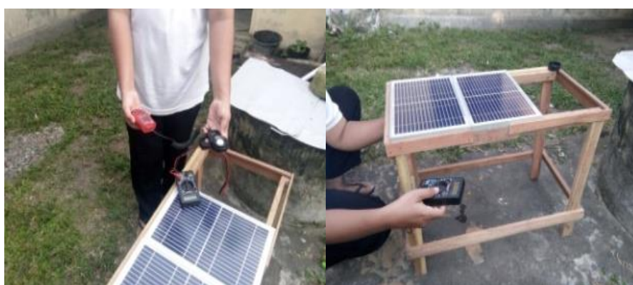
(a) (b) Gambar 10a,b Pengukuran suhu modul, iradiasi dan tegangan keluaran.
