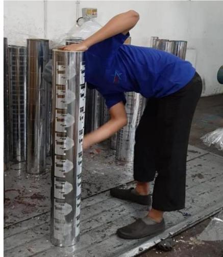
**Gambar 2.** Pencucian Silinder Menggunakan Solven.
