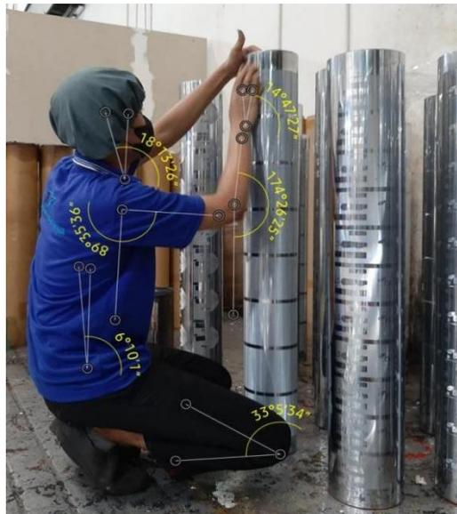
**Gambar 5.** Postur kerja aktifitas pengecekan silinder
