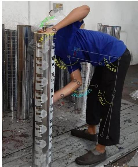
**Gambar 4.** Postur kerja aktifitas cuci silinder menggunakan solven
