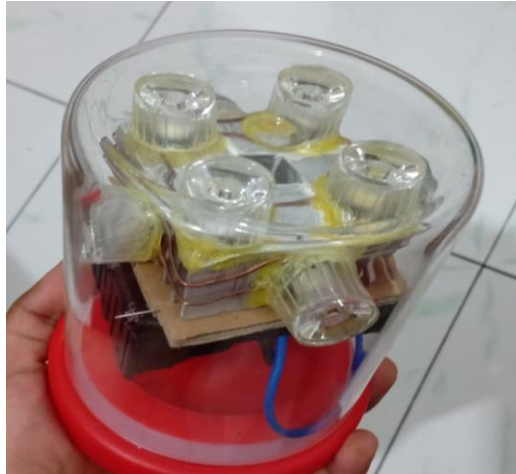
Gambar 6 Hasil konstruksi lampu LED celup. Sumber (Dokumentasi)
