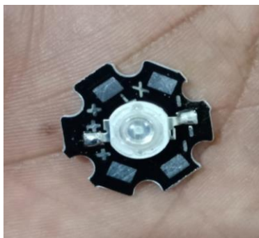
Gambar 7 Hasil rangkaian elektronik a). LED sudah dilekatkan pada PCB, b). Rangkaian pada lampu LED celup. Sumber (Dokumentasi)
