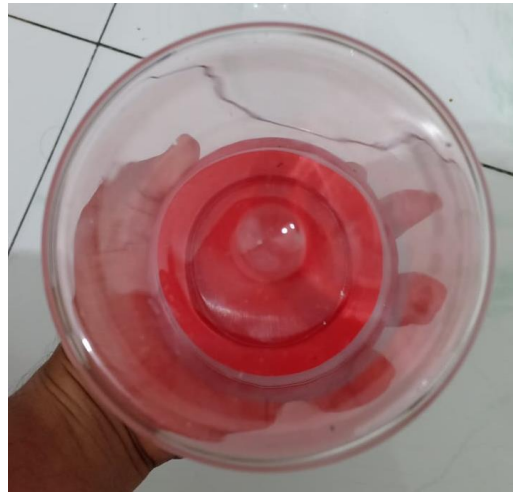
Gambar 8 Tabung pelindung lampu LED celup. Sumber (Dokumentasi)
