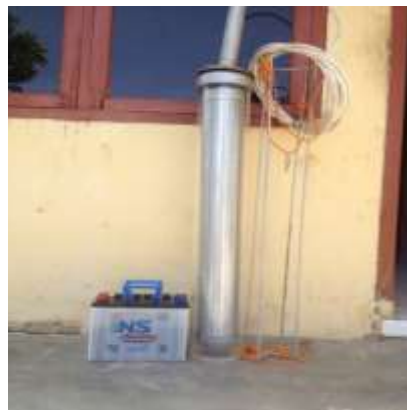
Gambar 3 Hasil konstruksi lampu LED celup.
