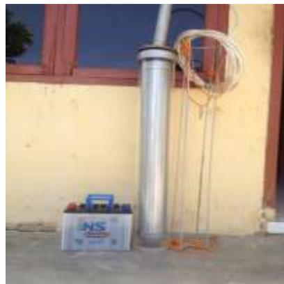
Gambar 3 Hasil konstruksi lampu LED celup.
