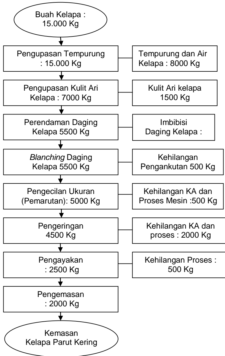
Gambar 1. Neraca Massa Kelapa pada setiap Fase Pengolahan
