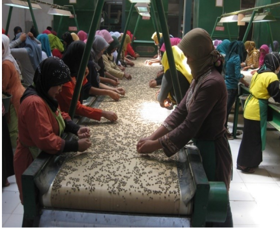
Gambar 9. Proses sortasi kopi beras di atas sabuk/ meja berjalan
