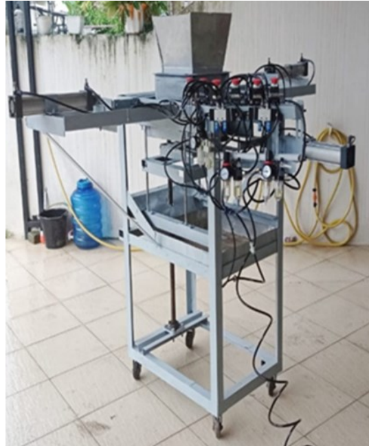
Gambar 2.4 mesin pencetak keripik tempe yang dibangun, lengkap dengan rangkaian sistem pneumatik
