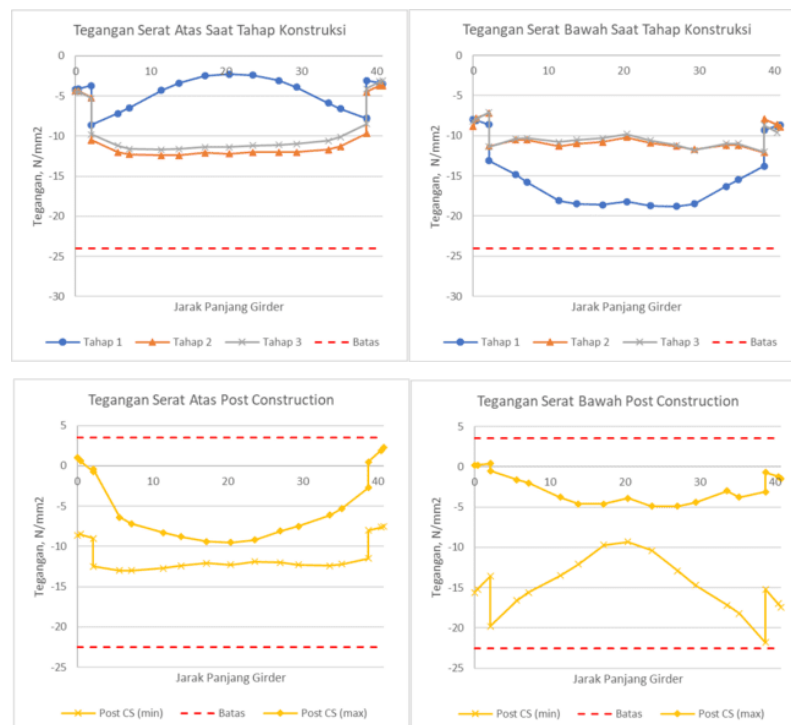
Gambar 7. Grafik Tegangan pada PCI Girder dengan Tinggi Pilar 30 Meter
