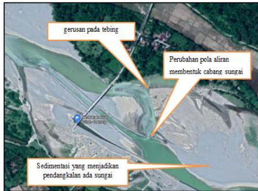
Gambar 1. Kondisi Sungai di Jembatan Alue Buloh
