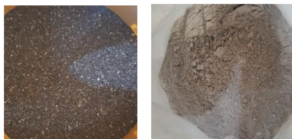
Gambar 1 Material cangkang keong lolos ayakan 4,75 mm dan 200 mm
